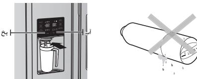
**فیلتر آبی که تازه نصب شده ممکن است موجب جهش آب از پخش گر آب به مدت کوتاهی شود، این به واسطه ورود هوا به لوله است. این موضوع بایسیستم مشکل در استفاده ایجاد کند.**
